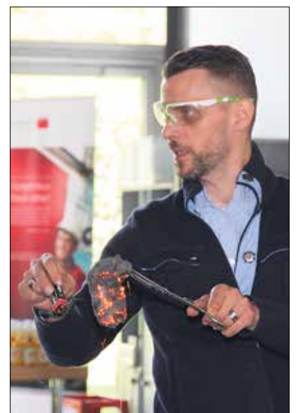
Zündende Mischung: vermeintlich leere Batterie mit benutzter Stahlwolle.
